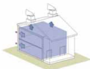
Construction hermétique avec ventilation naturelle contrôlée
