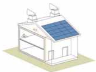
Panneaux photovoltaïques pour la production d'électricité
