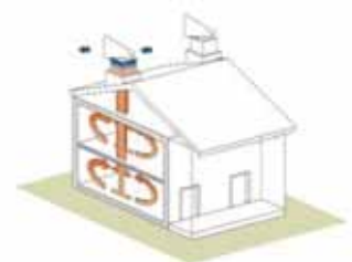
Ventilation naturelle à récupération de chaleur
